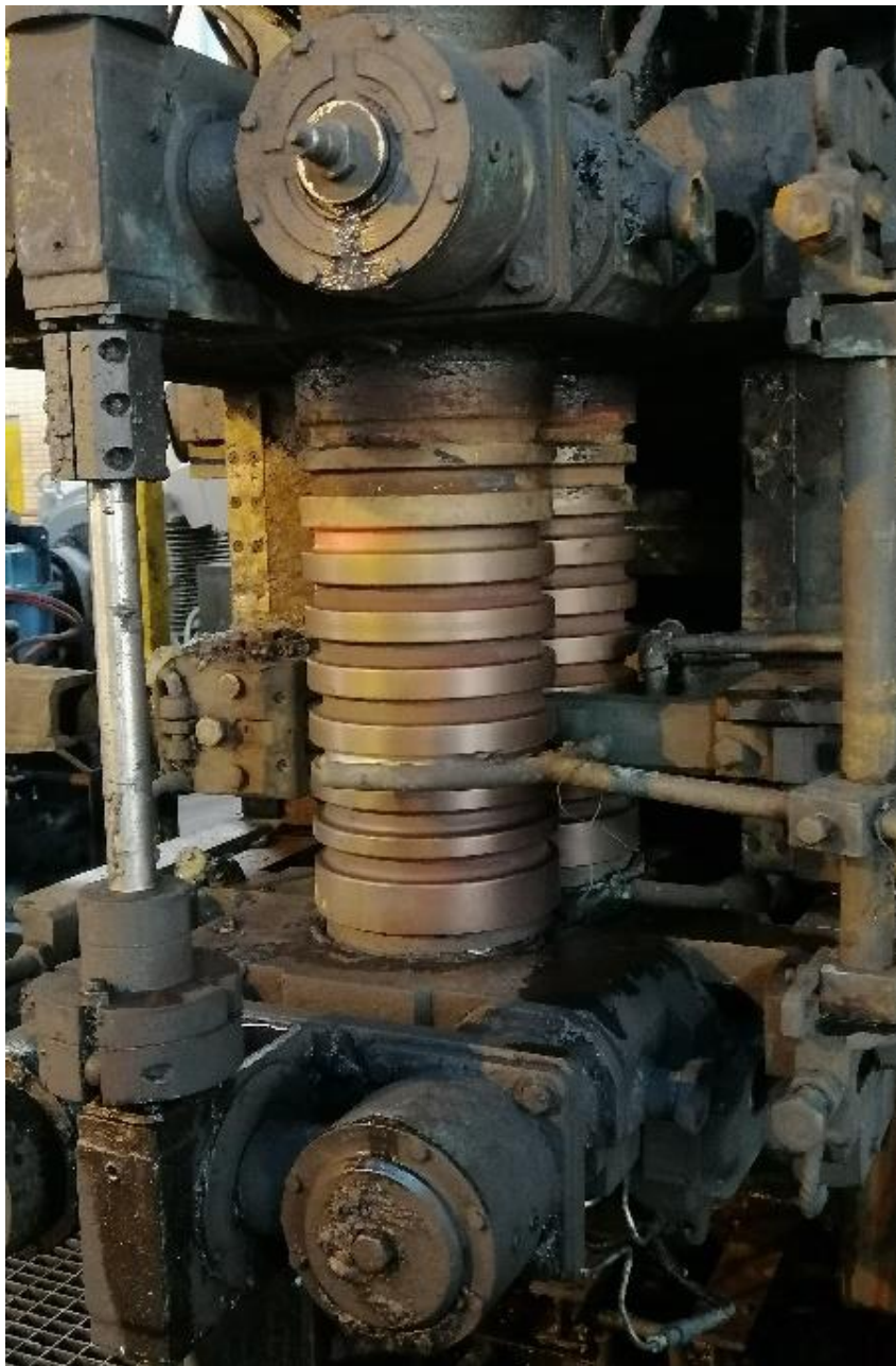
شکل ۲. نمونه‌ای از غلتک‌های داخل قفسه‌ی نورد
